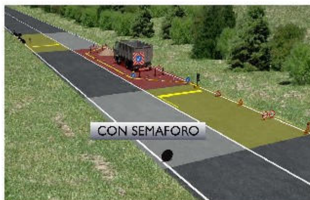
Barriera di cantiere con traffico alternato con semaforo
