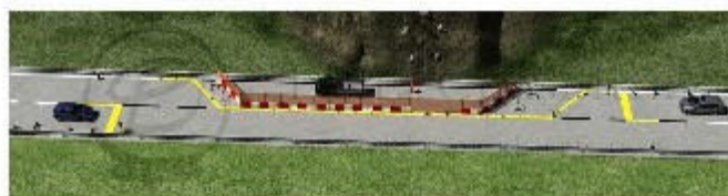
Barriera di cantiere con traffico alternato con semaforo
