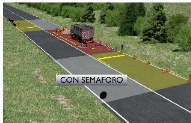
Dispositivo di cantiere con traffico alternato con semaforo
