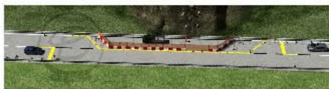
Dispositivo di cantiere con traffico alternato con semaforo
