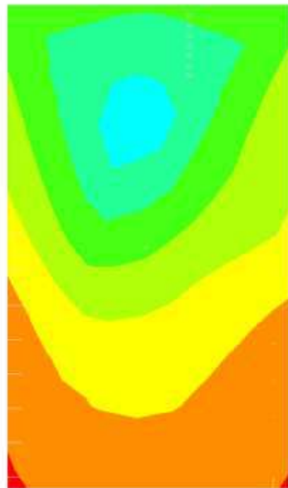
Rappresentazione in pianta delle massime compressioni sul terreno in famiglie SLE/SLD.
