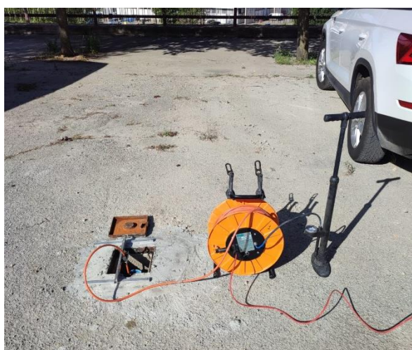
Geofono tridimensionale da foro PASI GFA-100
