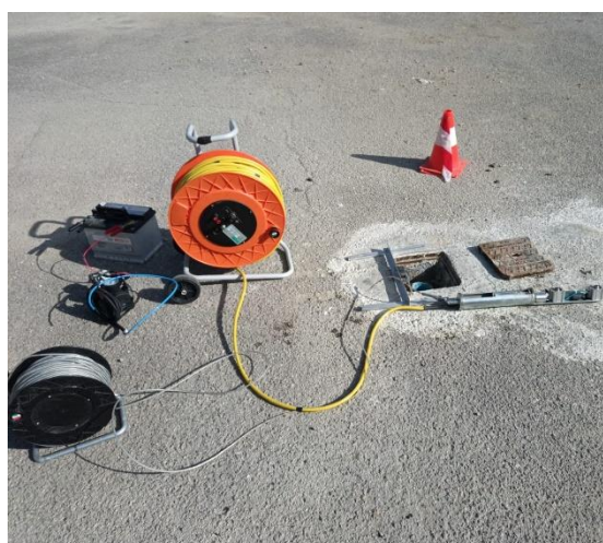
Energizzatore sismico per Cross-Hole "P/S waves"
