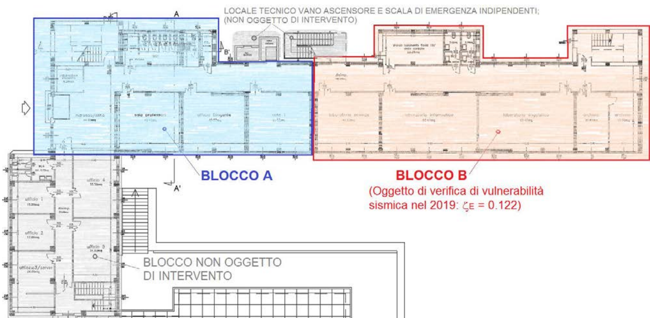
FIGURA 2.1 – STRALCIO PLANIMETRICO CON INDICAZIONE DEI CORPI DI FABBRICA OGGETTO DI ADEGUAMENTO SISMICO
