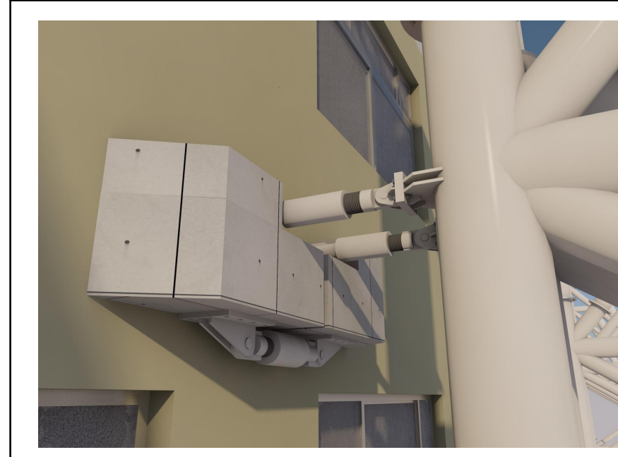
Nodo sul giunto tecnico
