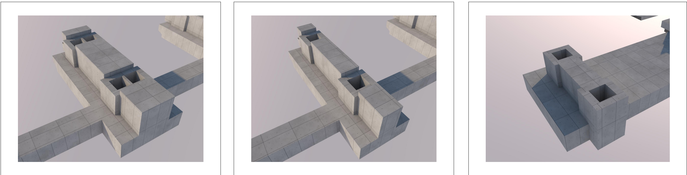
Schema fondazione in corrispondenza del giunto
