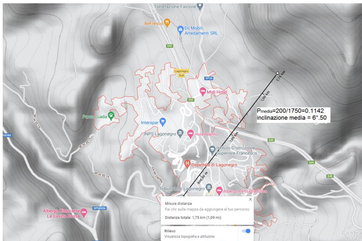
FIGURA 8.6 – STRALCIO DELLA PLANIMETRIA A CURVE DI LIVELLO CON VALUTAZIONE DELLA PENDENZA MEDIA DEL PENDIO
