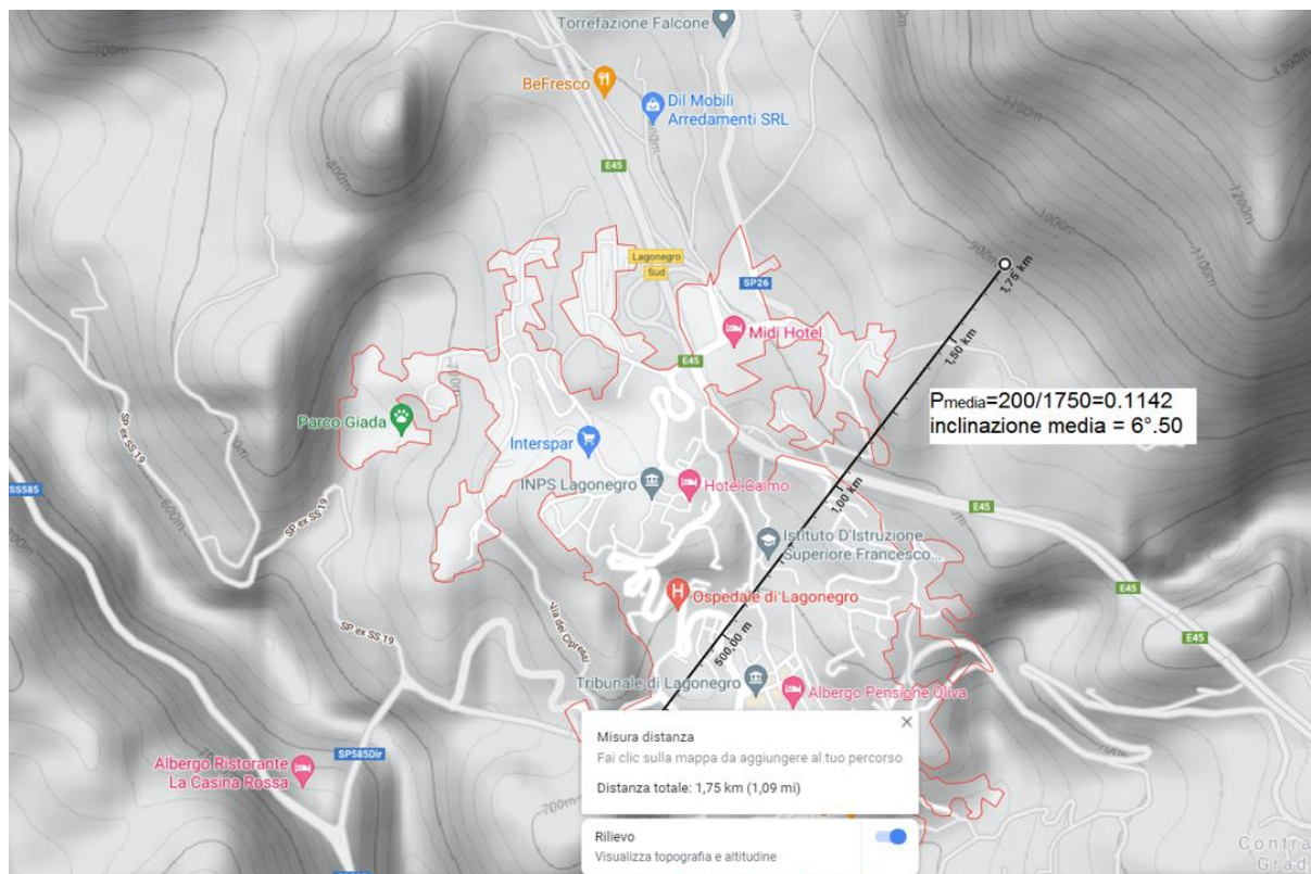
FIGURA 4.10 – STRALCIO DELLA PLANIMETRIA A CURVE DI LIVELLO CON VALUTAZIONE DELLA PENDENZA MEDIA DEL PENDIO
