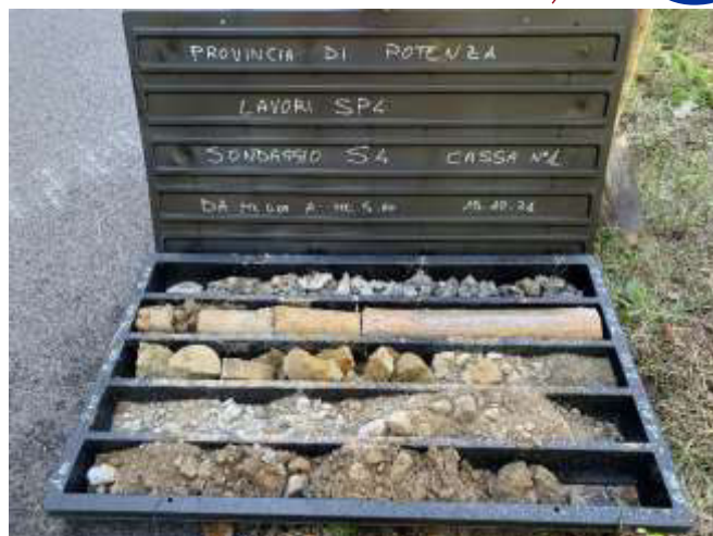
Foto n. 18: sondaggio S4 da mt 0 a mt 5
