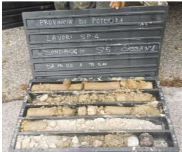
Foto n. 22: sondaggio S5 da mt 0 a mt 5
