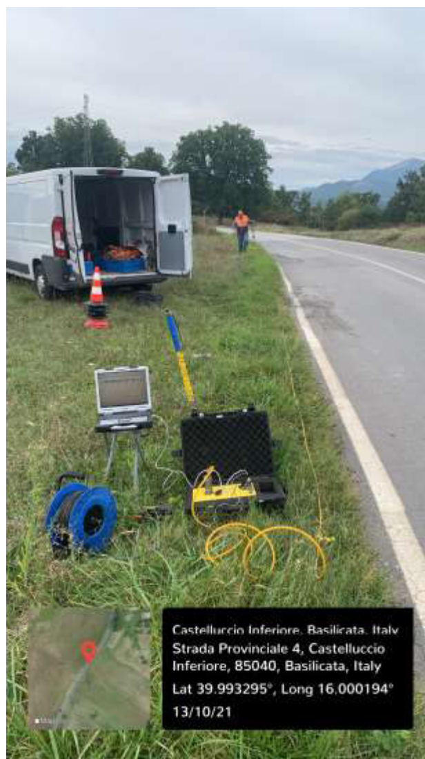
Foto n. 33: fase esecutiva prospezione sismica masw
