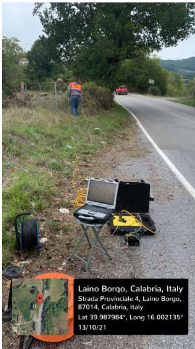
Foto n. 30: fase esecutiva prospezione sismica a rifrazione in onda P
