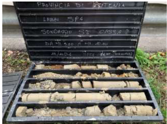
Foto n. 11: sondaggio S2 da mt 5 a mt 10
