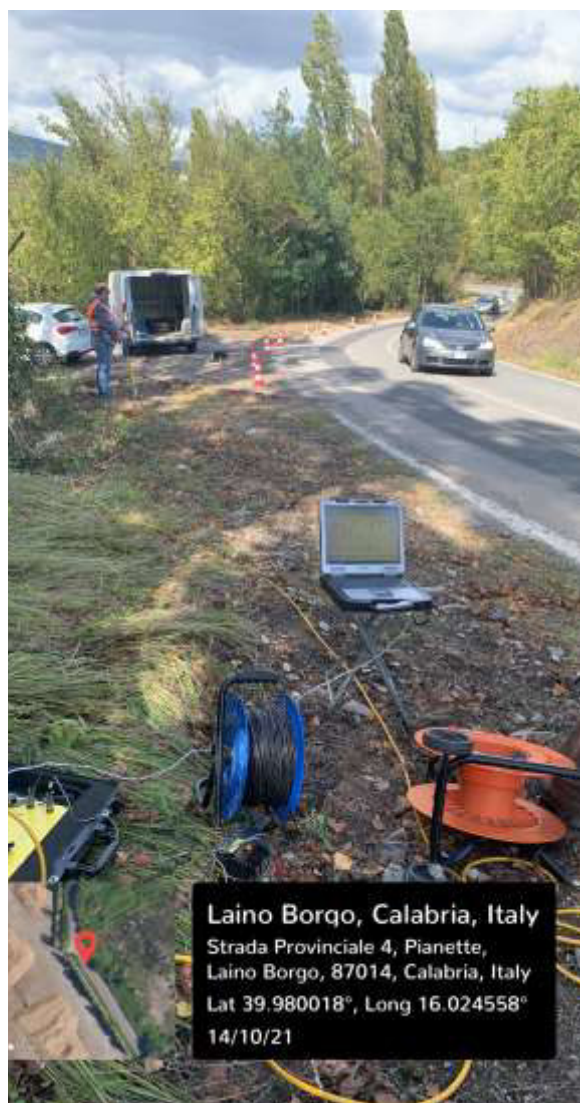
Foto n. 31: fase esecutiva prospezione sismica a rifrazione in onda P
