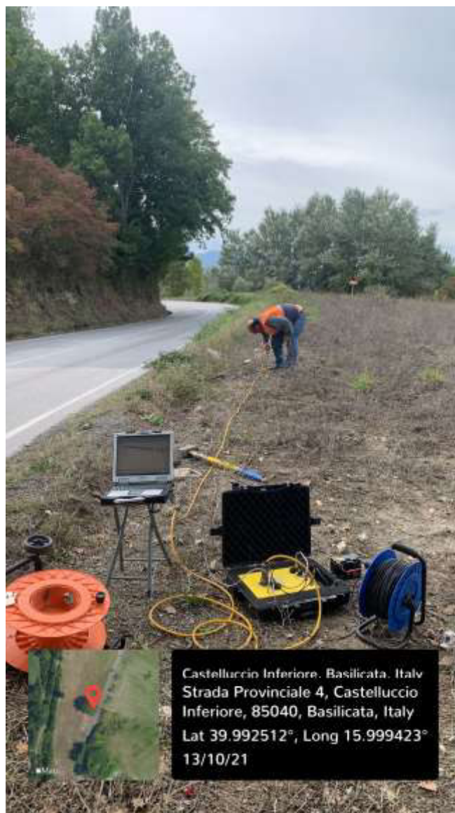
Foto n. 28: fase esecutiva prospezione sismica a rifrazione in onda P
