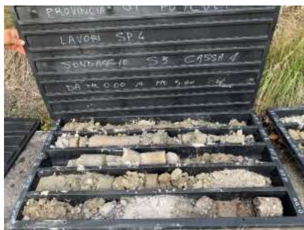
Foto n. 14: sondaggio S3 da mt 0 a mt 5
