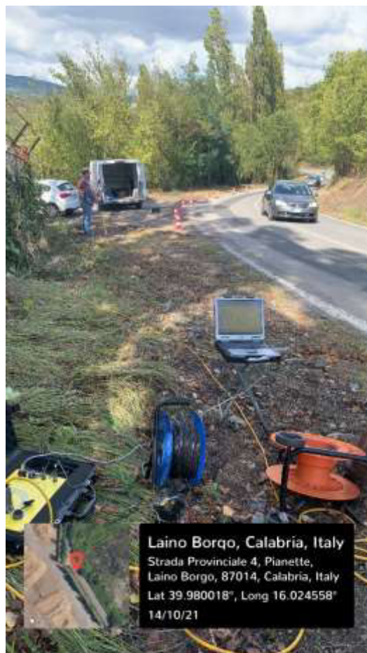
Foto n. 35: fase esecutiva prospezione sismica masw
