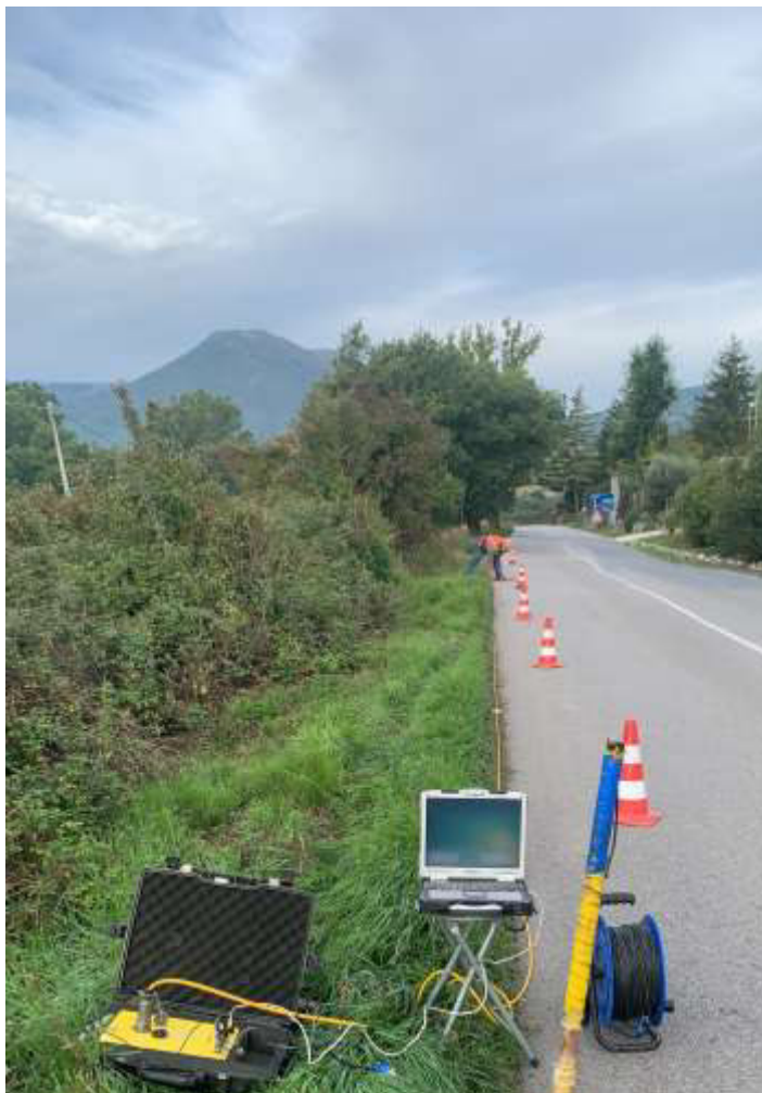
Foto n. 26: fase esecutiva prospezione sismica a rifrazione in onda P
