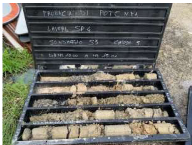
Foto n. 16: sondaggio S3 da mt 10 a mt 15
