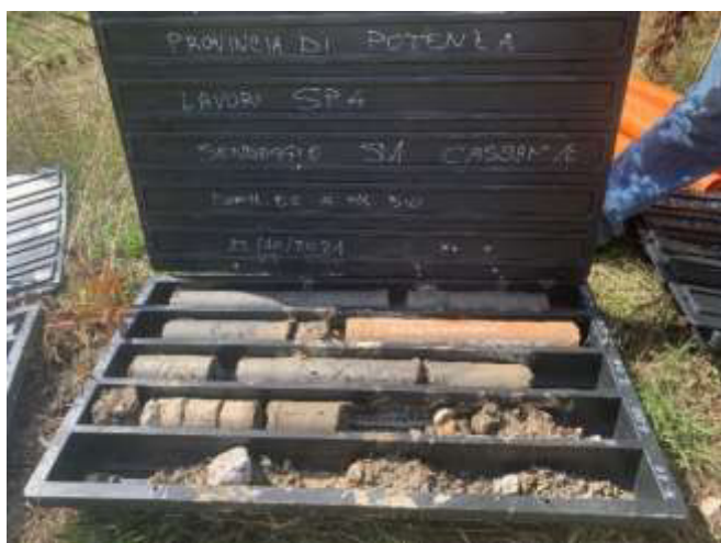
Foto n. 7: sondaggio S1 da mt 0 a mt 5
