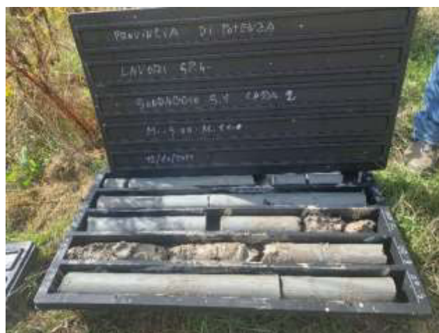
Foto n. 8: sondaggio S1 da mt 5 a mt 10
