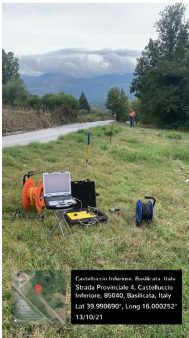
Foto n. 29: fase esecutiva prospezione sismica a rifrazione in onda P
