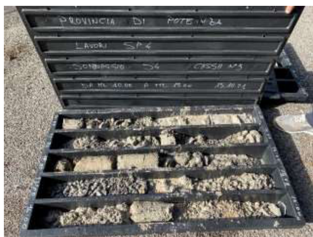
Foto n. 20: sondaggio S4 da mt 10 a mt 15
