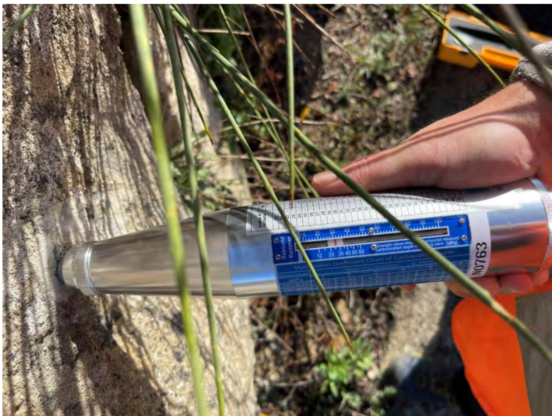
Figura 3 – Prova sclerometrica su fronte roccioso .
