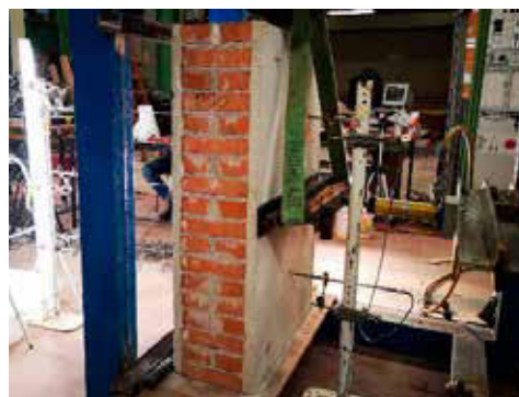
Schema prova di flessione fuori piano, posizionamento LVDT e martinetto idraulico - dimensioni muro per prova di flessione fuori piano e posizione connettori elicoidali in acciaio - setup di prova
