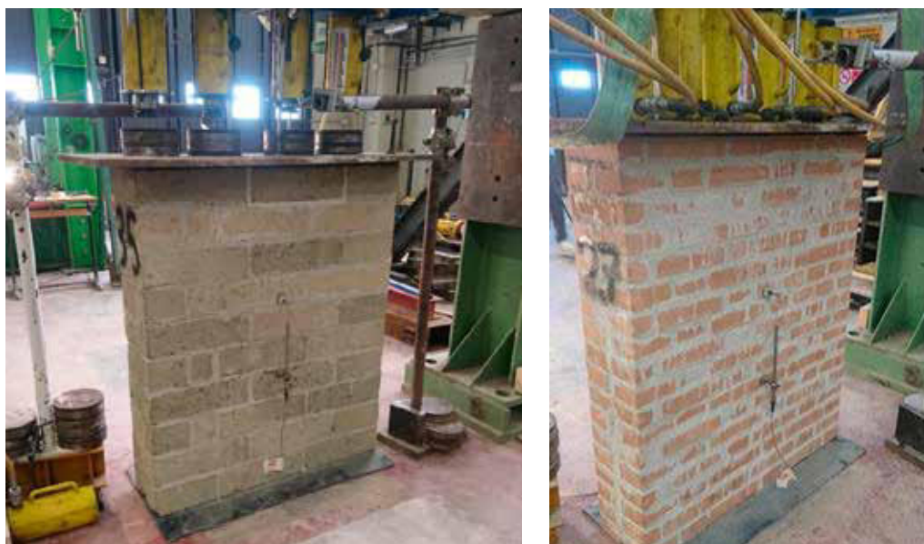
Prova di compressione semplice: setup di prova
