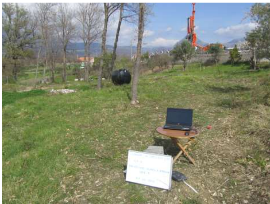
Fasi di acquisizione della prospezione sismica a rifrazione SR2 e della prospezione MASW2
