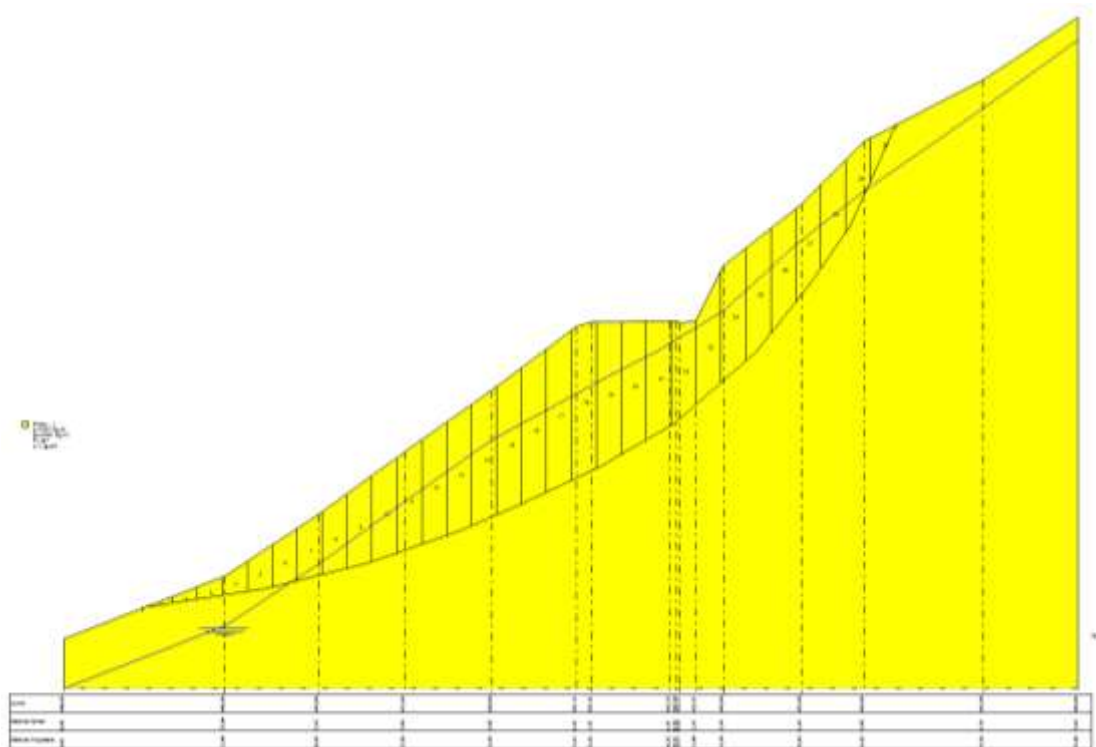
Fig.05: Sezione litotecnica di verifica nella back analysis
