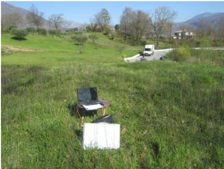
Fasi di acquisizione della prospezione sismica a rifrazione SR5 e della prospezione MASW3
