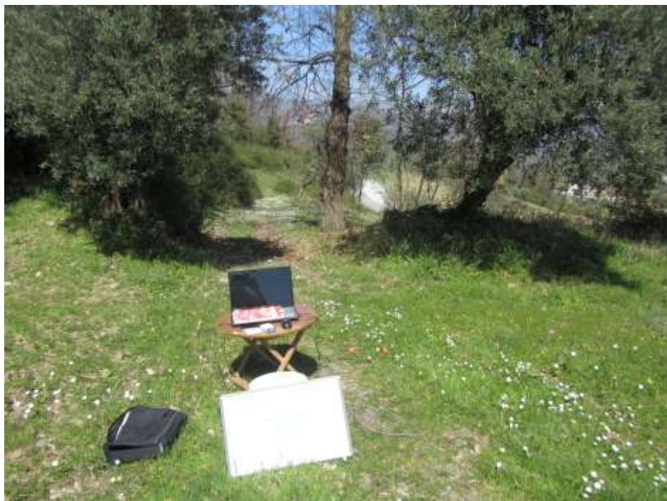
Fasi di acquisizione della prospezione sismica a rifrazione SR3
