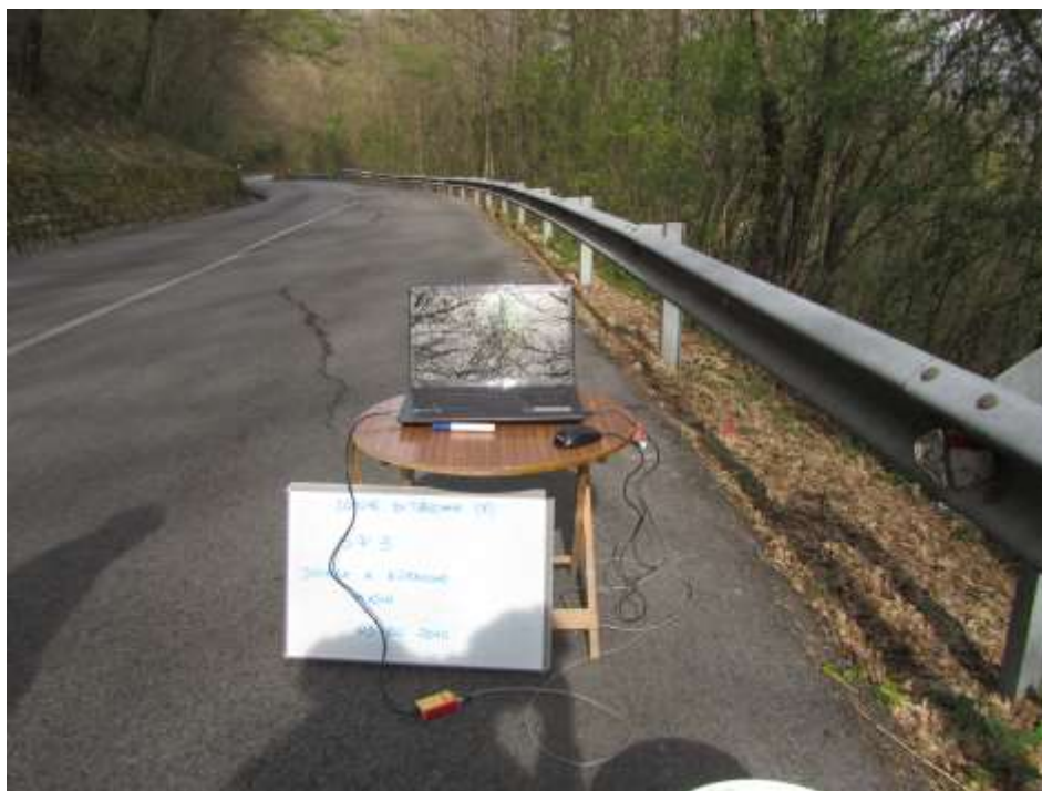
Fasi di acquisizione della prospezione sismica a rifrazione SR1 e della prospezione MASW1
